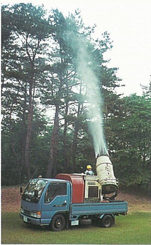
スパウターによる地上散布
