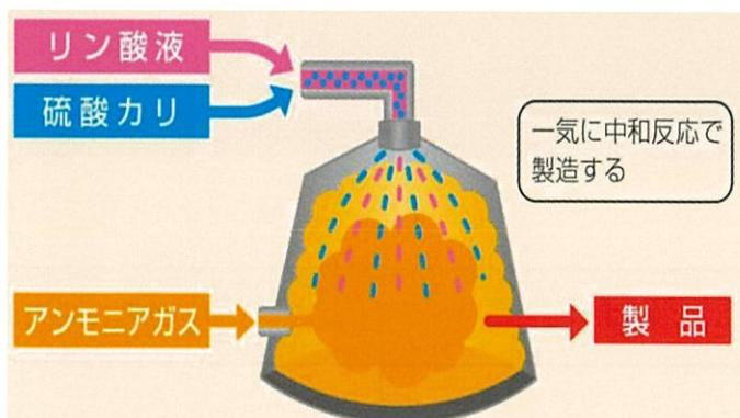
①反応塔上部からリン酸液に硫酸カリを溶解させた混合液を落下させる。
